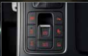
Valbart körläge Genom en knapptryckning kan du välja mellan växlingsläge Normal, Eco eller Sport. Normal för vardaglig körning, Eco för t ex bränsleeffektiva långkörningar och Sport för mer kraftfull körning. Standard Business och Business Plus utrustade med automatisk växellåda.
