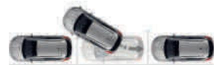
**Utbackningshjälpen** fungerar som Parkeringsassistansen fast omvänt, och hjälper dig manövrera ut från en fickparkering. Systemet styr bilen och du sköter gaspedal, bromspedal och växling. När systemet har manövrerat ut bilen ur utrymmet visas meddelandet "Ta över styrningen" i instrumentgruppen.
