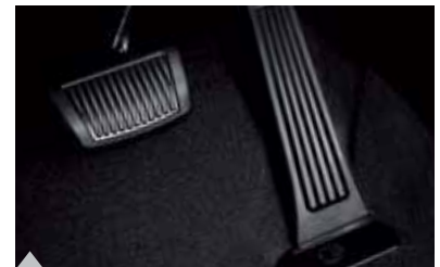
Gaspedal av "orgeltyp" Gaspedalen påminner om en pedal till en orgel, och ligger i samma naturliga vinkel som du håller foten. Detta förbättrar komforten, särskilt under långa resor.
